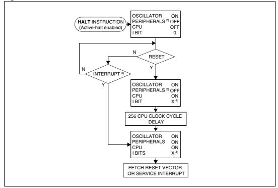
Figure 28. Active-halt mode flowchart
